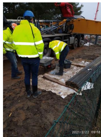
Zkoušky betonu zákl.desky ČOV
